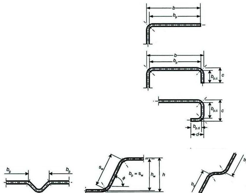
Figura C4.2.27 – Esempi di determinazione della larghezza  $b_p$
