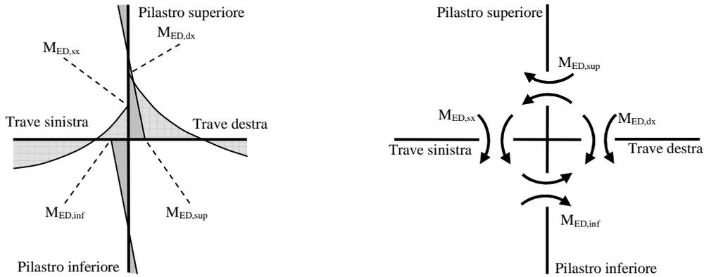
**Figura C4.1.2** Diagramma delle sollecitazioni e schema dei momenti trasmessi al nodo con momenti d'estremità discordi
