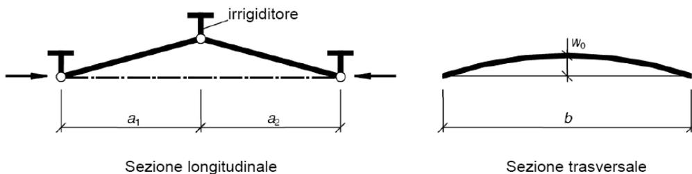
**Figura C4.2.18** Schema di calcolo per gli irrigiditori trasversali
