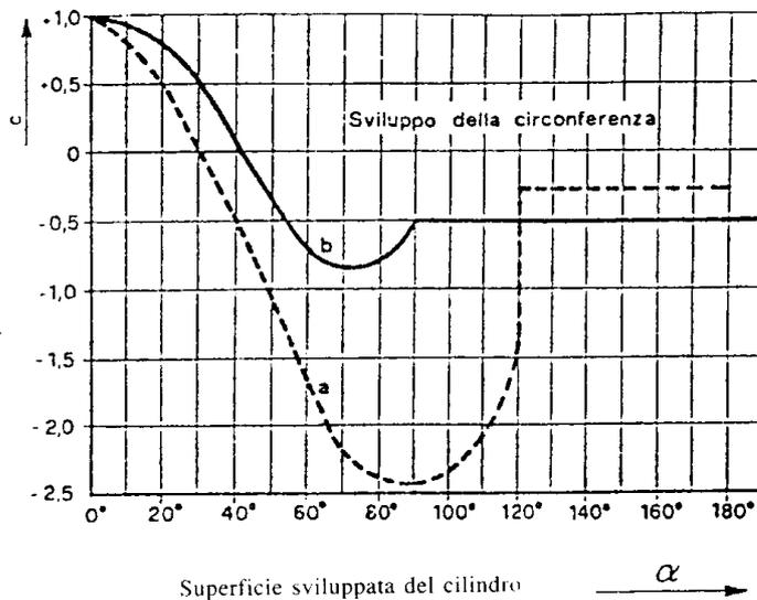
Curva a per superfici lisce (metalli, intonaco liscio)
