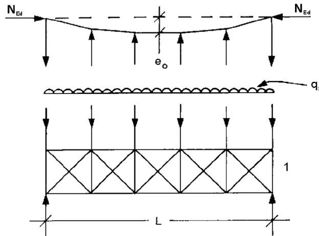
**Figura C4.2.5** Forze equivalenti in sistemi di controvento
