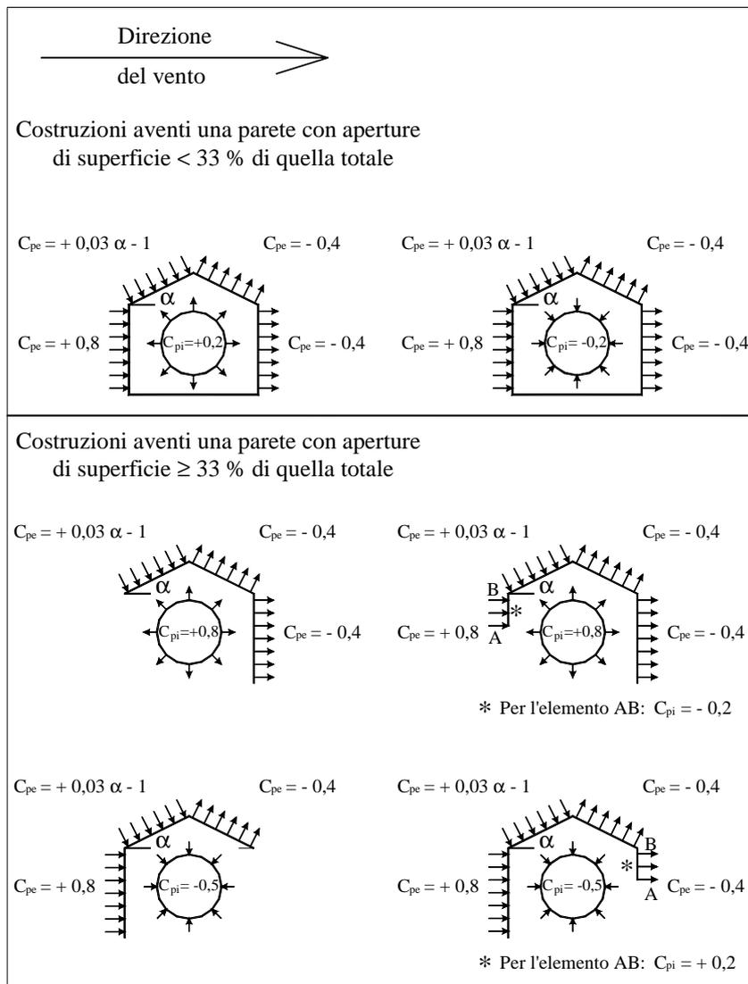
Figura C3.3.3 Coefficienti di forma per gli edifici.
