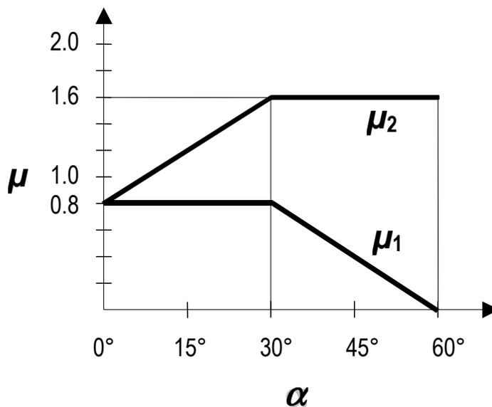
**Figura C3.4.1:** Coefficienti di forma per il carico neve
