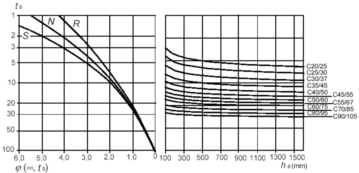
**Figura C4.3.10 (b).** Coefficiente  $\varphi(\infty; t_0)$  per umidità relativa pari all'80%
