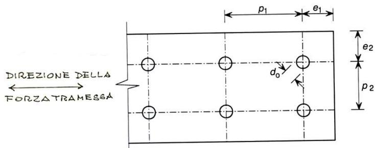
**Figura C4.2.34** – Parametri significativi per i collegamenti
