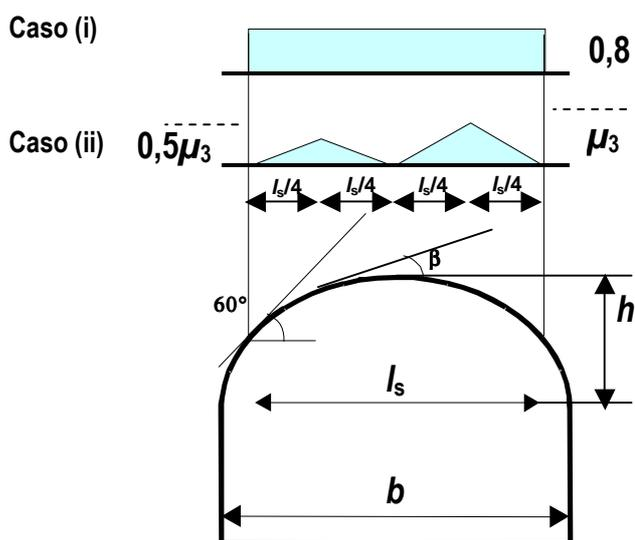
**Figura C3.4.3** Coefficiente di forma per il carico neve – coperture cilindriche
