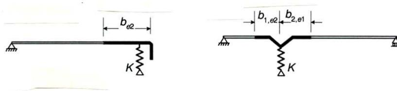
**Figura C4.2.31** – Schematizzazione degli irrigidimenti
